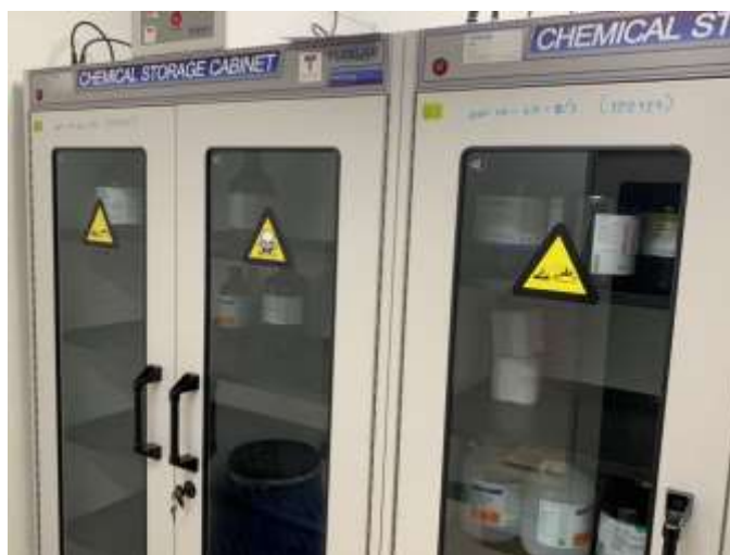
รูปที่ 4.8 ตู้เก็บสารเคมีประเภทกัดกร่อน
