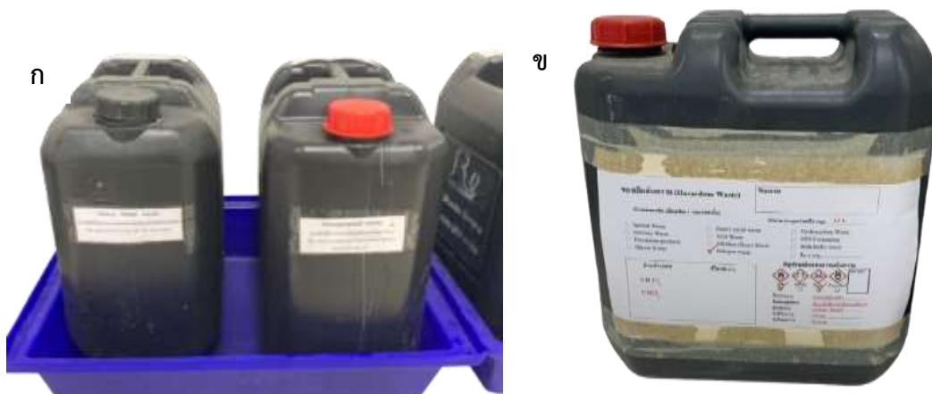
รูปที่ 4.11 การจัดเก็บของเสีย (ก) ภาชนะบรรจุของเสียพร้อมที่รองรับ (ข) ฉลากข้อมูลของเสียติดภาชนะ
